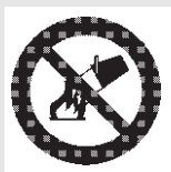
Verboden met water te blussen
